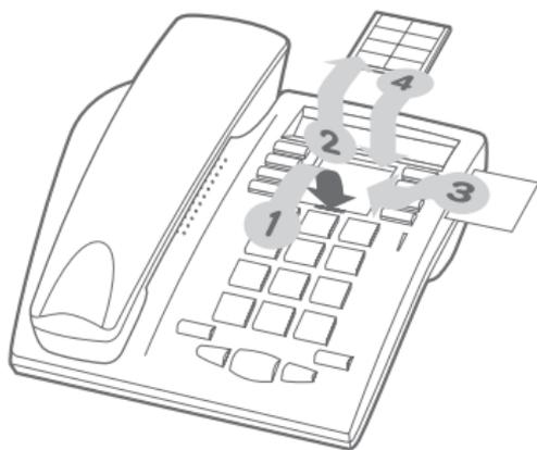
1. Insérez un objet à bout plat dans l'encoche (1 encoche par bloc de touches).
